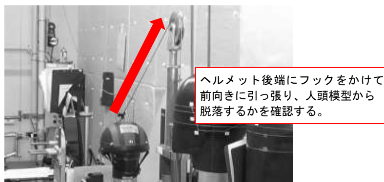
写真3. 保持装置の性能試験の様子
